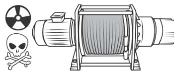
Estar cerca de químicos, gas corrosivo y/o explosivos puede causar explosión. Exposición al ácido y/o a la sal puede causar mal funcionamiento.
